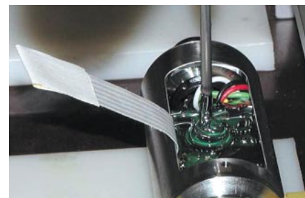
Bild 4. Sensorverguss mit Hochtemperatur-Gel ISO-PUR A 776
