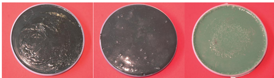
Bild 1. Typische Fehlerbilder, wie sie bei der manuellen Verarbeitung von Gießharzsystemen auftreten können: Schlieren (links) deuten auf ungenügende Mischung der Komponenten hin, Luftblasen (Mitte) können beim Mischen eigerührt werden und Schaumbildung (rechts) entsteht durch Feuchtigkeit im Material
