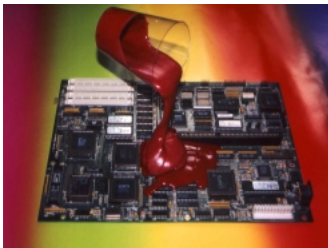
Bild 5 Polyurethanvergussmasse Iso-Cast A 765 mit Brandschutzzertifikat UL 94 VO
