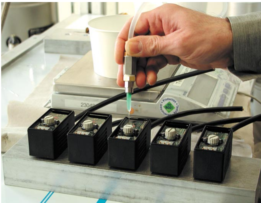
Bild 3. Beschichtung mit Leiterplattenlack ISO-RC 4000 per 1-K-Dispenser
