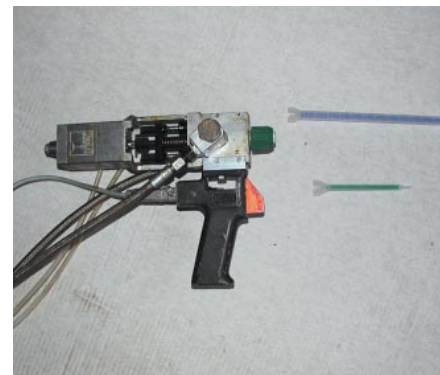
Bild 5. Mobiler Mischkopf mit statischem Mischrohr
